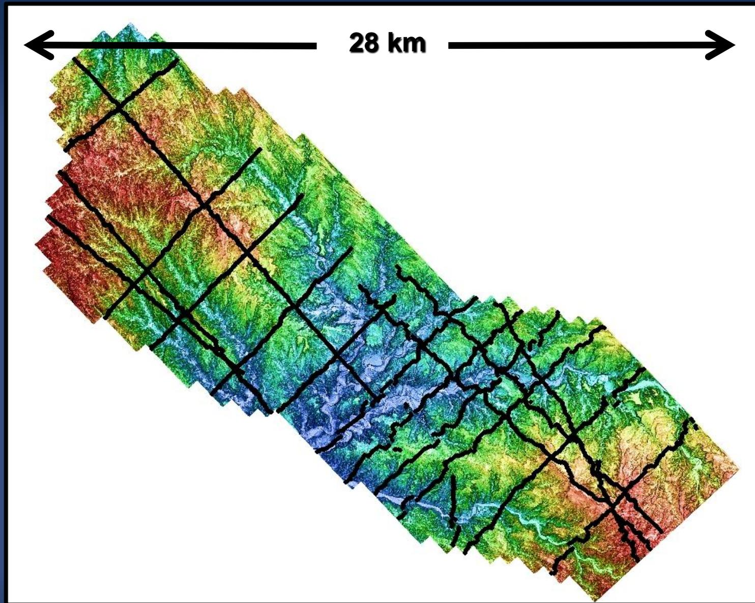
**2D seismic source points**
