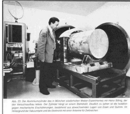
Abb. 23. Der Aluminiumzylinder des in München wiederholten Weber-Experimentes mit Heinz Billing, der den Versuchsaufbau leitete. Der Zylinder hängt an einem Stahndraht. Deutlich zu sehen ist die Isolierung gegen mechanische Erschütterungen, bestehend aus abwechselnden Lagen von Eisen und Gummi. Im Hintergrund der Vakuumtank und die Elektronik mit einer Antenne für Zeitschichten.
